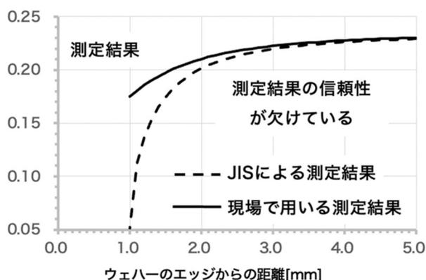
図2. 試料の縁の近くでの測定結果
